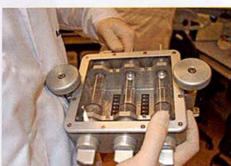
A FOCUS kísérleti eszköz összeszerelés és tesztelés utáni tesztje. Az ADMATIS kollégája a világításokat kapcsolja be. A berendezésben reverzibilis hőmérsékletmérő látható, amiről a pontos hőmérsékletet olvasta le az asztronauta az ISS-en.
